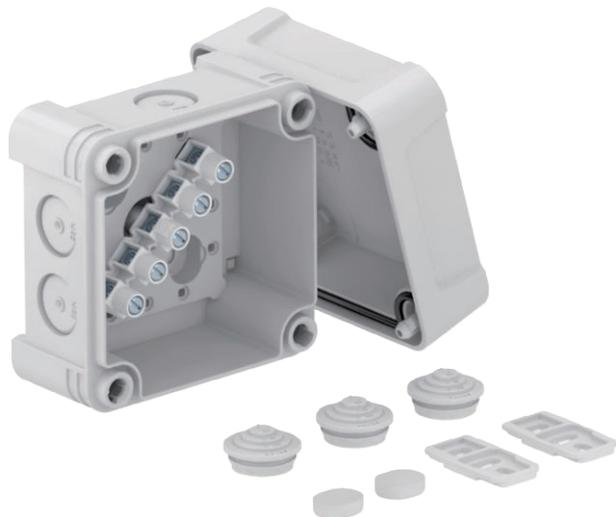
Scatola di derivazione con morsettieria per il collegamento di cavi e linee in ambienti interni ed ambienti esterni. Forma quadrata con inserti di deviazione. Adatta per il montaggio su pareti e soffitti con la possibilità di fissaggio esterno ed interno o il montaggio su sezioni angolari. Particolarmente resistente agli urti con IK09. Coperchio con chiusura rapida, piombabile. Costruito con materiali privi di alogeni e resistenti agli UV.
