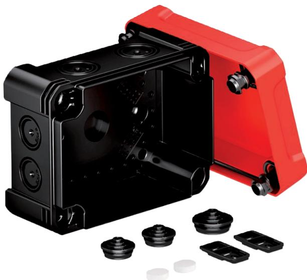
Scatola di derivazione per il collegamento di cavi e linee in ambienti interni ed ambienti esterni. Forma rettangolare con inserti di deviazione. Adatta per il montaggio su pareti e soffitti con la possibilità di fissaggio esterno ed interno o il montaggio su sezioni angolari. Particolarmente resistente agli urti con IK09. Coperchio con chiusura rapida, piombabile. Costruito con materiali privi di alogeni e resistenti agli UV.
