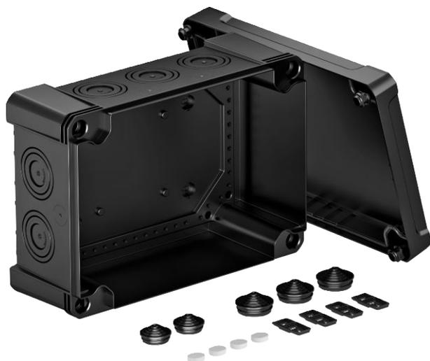
Scatola di derivazione per il collegamento di cavi e linee in ambienti interni ed ambienti esterni. Forma rettangolare con inserti di deviazione. Adatta per il montaggio su pareti e soffitti con la possibilità di fissaggio esterno ed interno o il montaggio su sezioni angolari. Particolarmente resistente agli urti con IK08. Coperchio con chiusura rapida, piombabile. Costruito con materiali privi di alogeni e resistenti agli UV.
