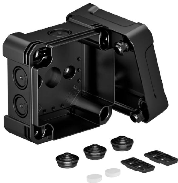
Scatola di derivazione per il collegamento di cavi e linee in ambienti interni ed ambienti esterni. Forma quadrata con inserti di deviazione. Adatta per il montaggio su pareti e soffitti con la possibilità di fissaggio esterno ed interno o il montaggio su sezioni angolari. Particolarmente resistente agli urti con IK09. Coperchio con chiusura rapida, piombabile. Costruito con materiali privi di alogeni e resistenti agli UV.
