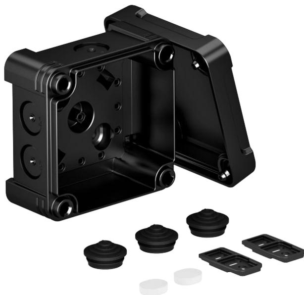
Scatola di derivazione per il collegamento di cavi e linee in ambienti interni ed ambienti esterni. Forma quadrata con inserti di deviazione. Adatta per il montaggio su pareti e soffitti con la possibilità di fissaggio esterno ed interno o il montaggio su sezioni angolari. Particolarmente resistente agli urti con IK09. Coperchio con chiusura rapida, piombabile. Costruito con materiali privi di alogeni e resistenti agli UV.
