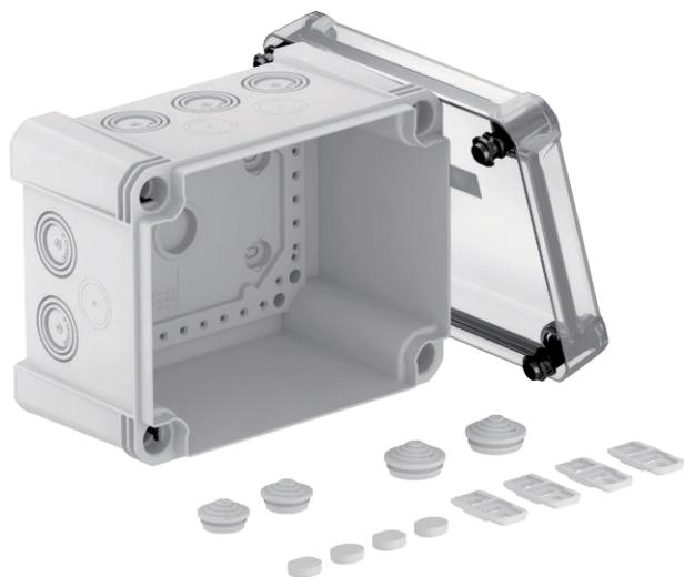
Scatola di derivazione per il collegamento di cavi e linee in ambienti interni ed ambienti esterni. Forma rettangolare con inserti di deviazione. Adatta per il montaggio su pareti e soffitti con la possibilità di fissaggio esterno ed interno o il montaggio su sezioni angolari. Particolarmente resistente agli urti con IK09. Coperchio trasparente con chiusura rapida, piombabile. Costruito con materiali privi di alogeni e resistenti agli UV.
