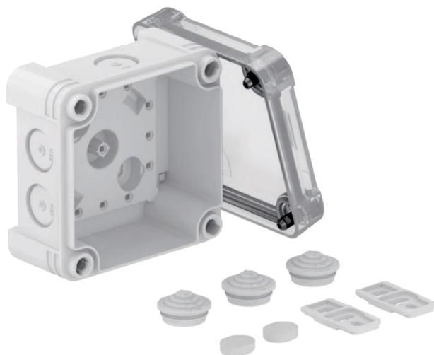
Scatola di derivazione per il collegamento di cavi e linee in ambienti interni ed ambienti esterni. Forma quadrata con inserti di deviazione. Adatta per il montaggio su pareti e soffitti con la possibilità di fissaggio esterno ed interno o il montaggio su sezioni angolari. Particolarmente resistente agli urti con IK09. Coperchio trasparente con chiusura rapida, piombabile. Costruito con materiali privi di alogeni e resistenti agli UV.
