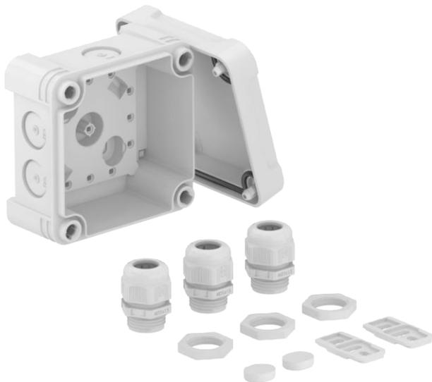
Scatola di derivazione per il collegamento di cavi e linee in ambienti interni ed ambienti esterni. Forma quadrata con inserti di deviazione. Adatta per il montaggio su pareti e soffitti con la possibilità di fissaggio esterno ed interno o il montaggio su sezioni angolari. Particolarmente resistente agli urti con IK09. Coperchio con chiusura rapida, piombabile. Costruito con materiali privi di alogeni e resistenti agli UV.
