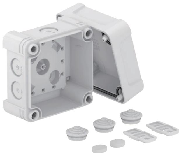
Scatola di derivazione per il collegamento di cavi e linee in ambienti interni ed ambienti esterni. Forma quadrata con inserti di deviazione. Adatta per il montaggio su pareti e soffitti con la possibilità di fissaggio esterno ed interno o il montaggio su sezioni angolari. Particolarmente resistente agli urti con IK09. Coperchio con chiusura rapida, piombabile. Costruito con materiali privi di alogeni e resistenti agli UV.
