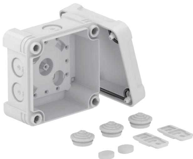
Scatola di derivazione per il collegamento di cavi e linee in ambienti interni ed ambienti esterni. Forma quadrata con inserti di deviazione. Adatta per il montaggio su pareti e soffitti con la possibilità di fissaggio esterno ed interno o il montaggio su sezioni angolari. Particolarmente resistente agli urti con IK09. Coperchio con chiusura rapida, piombabile. Costruito con materiali privi di alogeni e resistenti agli UV.
