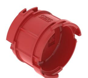
Supporto distanziatore con chiusura a baionetta per la combinazione stabile di scatole da incasso multiple. Per aumentare la distanza standard di 71 mm di ulteriori 20 mm.
