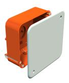
Scatola di derivazione per intercapedini per l'impiego in intercapedini con una profondità di installazione di almeno 50 mm e uno spessore pannelli di 7 -35 mm. Con coperchio bianco e viti del coperchio Adatta per il montaggio di profilati a norma (profilati di sospensione e di supporto) per morsetti in linea.
