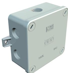
B 9 K ...: Grado di protezione IP 67, scatola vuota per l'impiego con morsetti singoli 4 viti di copertura in plastica, quindi totalmente anticorrosione 2 piedi di fissaggio per viti di Ø fino a 5 mm , 7 fori passanti apribili con filettatura Pg 16 con 3 pressacavi in poliammide per cavi con Ø di 10-14 mm tipo 106/16 B9K. I pressacavi hanno una speciale filettatura che al momento dell'avvitamento apre automaticamente il foro passante.
