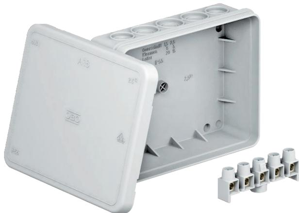
Grado di protezione IP55, tensione nominale 690 V, sezione nominale 2,5 mm<sup>2</sup>, 10 fori entrate cavi per cavi di diametro di 5-14 mm e 8 fori entrate cavi per cavi di diametro di 5-11 mm.
