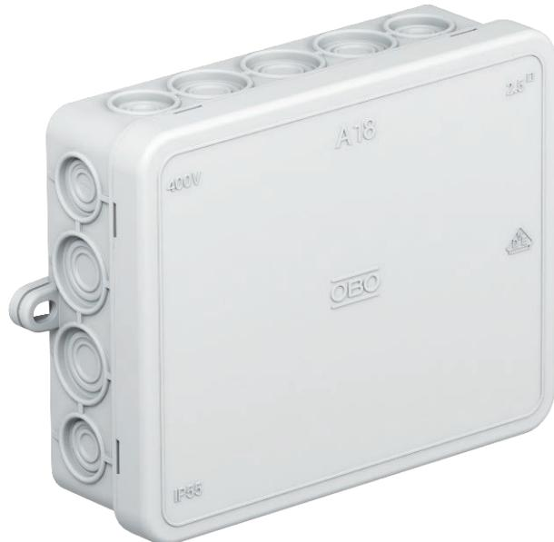
Grado di protezione IP55, tensione nominale 400 V, sezione nominale 2,5 ÷ mm<sup>2</sup>, 10 ingressi per cavi di diametro 5-14 mm
