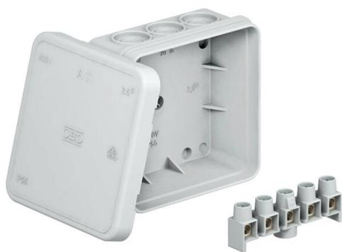
Grado di protezione IP55, tensione nominale 690 V, sezione nominale 2,5 mm<sup>2</sup>, 12 ingressi per diametro cavo 5-14 mm.
