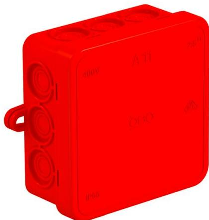
Grado di protezione IP55, tensione nominale 690 V, sezione nominale 2,5 mm<sup>2</sup>, 12 ingressi per diametro cavo 5-14 mm.
