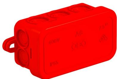
Grado di protezione IP55, tensione nominale 690 V, sezione nominale 2,5 mm<sup>2</sup>, 6 ingressi per diametro cavo 5-14 mm
