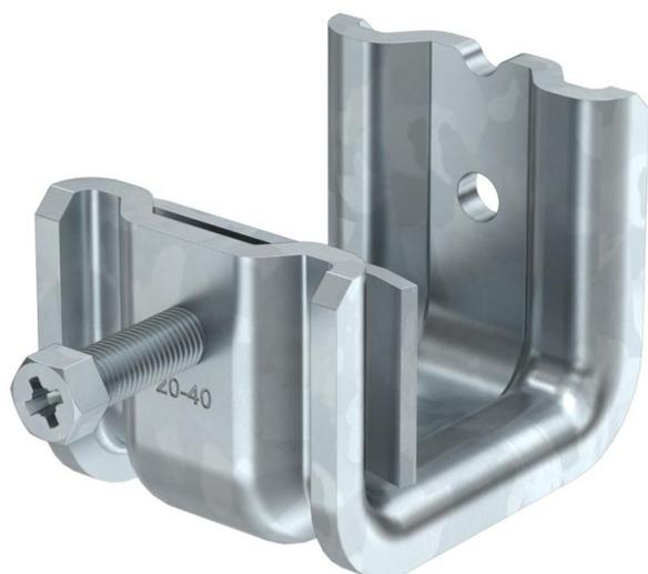
Questo tipo di graffe di supporto viene spinto sulle travi e fissato con coppa e vite (M8) alla trave o ai profilati piatti. La vite a testa esagonale ha un'apertura di chiave di 10 mm. Nella fascetta sono inoltre presenti due altre filettature M6, per fissare per esempio delle aste filettate.
