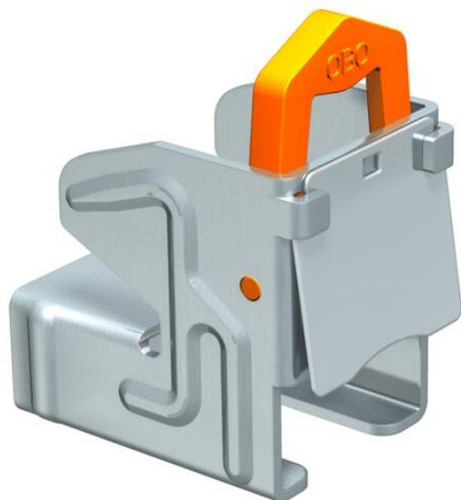
Graffa supporto con rivestimento antiruggine senza viti, con molla di ritenzione adatta per profilati tipo CML3518 e CMS 3518. Per il fissaggio rapido ai profilati d'acciaio in caso di montaggio di fasci di cavi, porta lampade, staffe reggicavo ecc. Il sistema completo è composto da 2 graffe di supporto e un profilato a C con lunghezza a scelta, nonché da 2 calotte di protezione.
