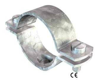
Collare distanziatore, con filettatura M8. La dimensione 27 FT è adatta per M25. La dimensione 42.5 FT è adatta per M40. La dimensione 48.5 FT è adatta per M50 La dimensione 60 FT è adatta per M63
