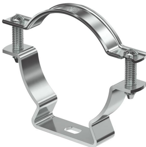
Collare di fissaggio per il montaggio di tubi e cavi a parete, soffitto e pavimento. Con elemento superiore autobloccante. Fissaggio tramite foro ovale. A partire dalla dimensione 20 dei collari idoneità per il montaggio con sparabulloni o sparachiodi.
