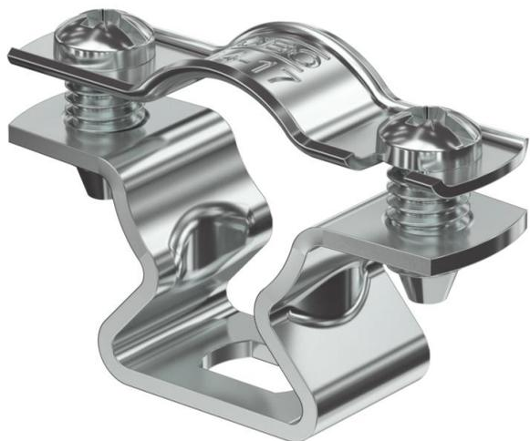
Collare di fissaggio per il montaggio di tubi e cavi a parete, soffitto e pavimento. Con elemento superiore autobloccante. Fissaggio tramite foro ovale. A partire dalla dimensione 20 dei collari idoneità per il montaggio con sparabulloni o sparachiodi.
