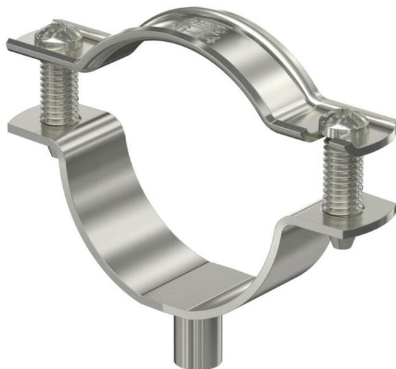
Collare di fissaggio per il montaggio di tubi e cavi a parete, soffitto e pavimento. Con elemento superiore autobloccante. Fissaggio sopra supporto con filettatura interna. Superfici G ed FT a partire dalla dimensione 20 dei collari adatte per montaggio con sparabulloni o sparachiodi.
