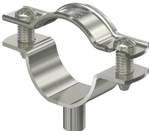
Collare di fissaggio per il montaggio di tubi e cavi a parete, soffitto e pavimento. Con elemento superiore autobloccante. Fissaggio sopra supporto con filettatura interna. Superfici G ed FT a partire dalla dimensione 20 dei collari adatte per montaggio con sparabulloni o sparachiodi.
