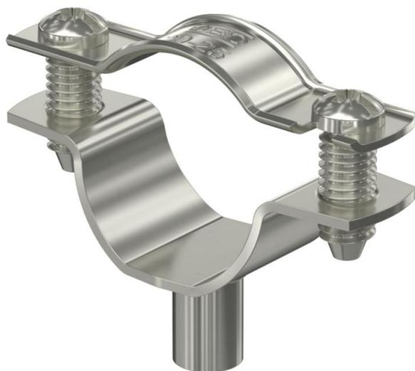
Collare di fissaggio per il montaggio di tubi e cavi a parete, soffitto e pavimento. Con elemento superiore autobloccante. Fissaggio sopra supporto con filettatura interna. Superfici G ed FT a partire dalla dimensione 20 dei collari adatte per montaggio con sparabulloni o sparachiodi.
