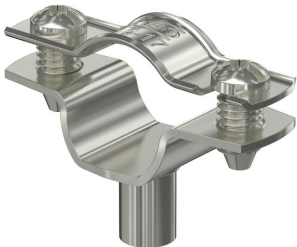
Collare di fissaggio per il montaggio di tubi e cavi a parete, soffitto e pavimento. Con elemento superiore autobloccante. Fissaggio sopra supporto con filettatura interna. Superfici G ed FT a partire dalla dimensione 20 dei collari adatte per montaggio con sparabulloni o sparachiodi.
