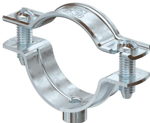
Collare di fissaggio per il montaggio di tubi e cavi a parete, soffitto e pavimento. Con elemento superiore autobloccante. Fissaggio sopra supporto con filettatura interna. Superfici G ed FT a partire dalla dimensione 20 dei collari adatte per montaggio con sparambulloni o sparachiodi.
