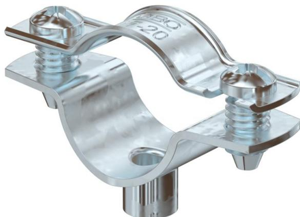
Collare di fissaggio per il montaggio di tubi e cavi a parete, soffitto e pavimento. Con elemento superiore autobloccante. Fissaggio sopra supporto con filettatura interna. Superfici G ed FT a partire dalla dimensione 20 dei collari adatte per montaggio con sparavviti o sparachiodi.
