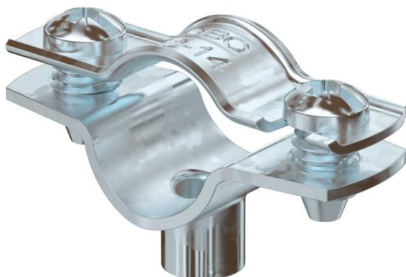
Collare di fissaggio per il montaggio di tubi e cavi a parete, soffitto e pavimento. Con elemento superiore autobloccante. Fissaggio sopra supporto con filettatura interna. Superfici G ed FT a partire dalla dimensione 20 dei collari adatte per montaggio con sparavviti o sparachiodi.
