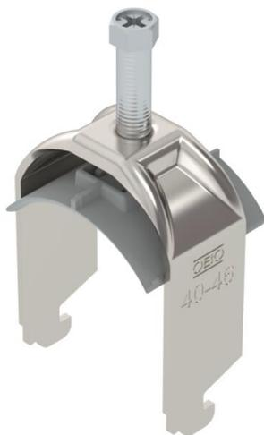
Staffa reggicavo con ancoraggio tipo N, coppa plastica in polipropilene. Per il montaggio verticale e orizzontale di 1 cavo singolo su profilato a C con scanalatura di larghezza 11 - 12 mm. Dotata di vite SW10 per il serraggio della coppa tramite testa esagonale o intaglio a croce. Per il montaggio in ambiente interno ed esterno. Si raccomanda l'uso della controcoppa, da ordinare separatamente.
