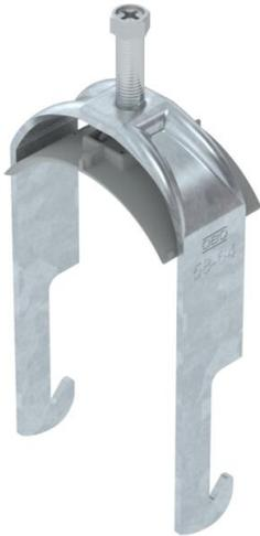
Staffa reggicavo con ancoraggio tipo W, coppa plastica in polipropilene. Per il montaggio verticale e orizzontale di 1 cavo singolo su profilato angolare fino a <40 mm. Dotata di vite SW10 per il serraggio della coppa tramite testa esagonale o intaglio a croce. Per il montaggio in ambiente interno ed esterno. Si raccomanda l'uso della controcoppa, da ordinare separatamente.
