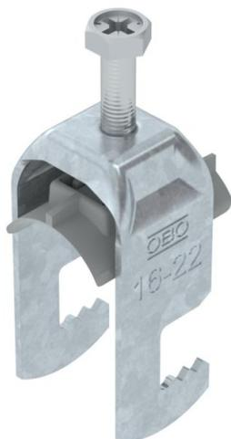
Staffa reggicavo con ancoraggio tipo F, coppa plastica in polipropilene. Per il montaggio verticale e orizzontale di 1 cavo singolo su profilato piatto. Dotata di vite SW10 per il serraggio della coppa tramite testa esagonale o intaglio a croce. Per il montaggio in ambiente interno ed esterno. Si raccomanda l'uso della controcoppa, da ordinare separatamente.
