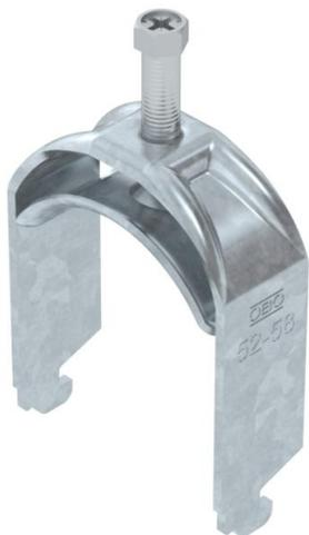
Staffa reggicavo con ancoraggio tipo N, coppa in metallo con bordi arrotondati a protezione del cavo. Per il montaggio verticale e orizzontale di 1 cavo singolo su profilato a C con scanalatura di larghezza 11 - 12 mm. Dotata di vite SW10 per il serraggio della coppa tramite testa esagonale o intaglio a croce. Per il montaggio in ambiente interno ed esterno. Si raccomanda l'uso della controcoppa, da ordinare separatamente.
