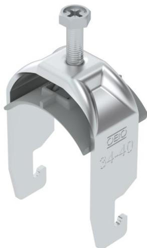
Staffa reggicavo con ancoraggio tipo U, coppa plastica in polipropilene. Per il montaggio verticale e orizzontale di 1 cavo singolo su profilato a C con scanalatura di larghezza 18 - 22 mm. Dotata di vite SW10 per il serraggio della coppa tramite testa esagonale o intaglio a croce. Per il montaggio in ambiente interno ed esterno. Si raccomanda l'uso della controcoppa, da ordinare separatamente.
