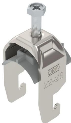
Staffa reggicavo con ancoraggio tipo U, coppa plastica in polipropilene. Per il montaggio verticale e orizzontale di 1 cavo singolo su profilato a C con scanalatura di larghezza 18 - 22 mm. Dotata di vite SW10 per il serraggio della coppa tramite testa esagonale o intaglio a croce. Per il montaggio in ambiente interno ed esterno. Si raccomanda l'uso della controcoppa, da ordinare separatamente.
