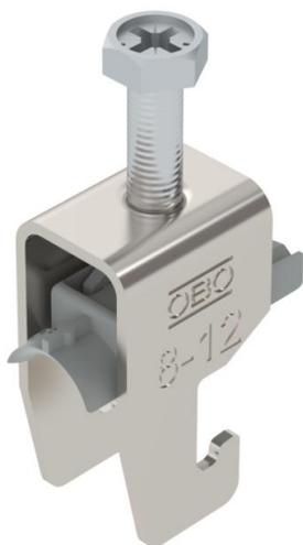
Staffa reggicavo con ancoraggio tipo U, coppa plastica in polipropilene. Per il montaggio verticale e orizzontale di 1 cavo singolo su profilato a C con scanalatura di larghezza 18 - 22 mm. Dotata di vite SW10 per il serraggio della coppa tramite testa esagonale o intaglio a croce. Per il montaggio in ambiente interno ed esterno. Si raccomanda l'uso della controcoppa, da ordinare separatamente.
