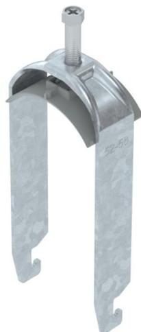
Staffa reggicavo con ancoraggio tipo U, coppa plastica in polipropilene. Per il montaggio verticale e orizzontale di 2 cavi singoli su profilato a C con scanalatura di larghezza 18 - 22 mm. Dotata di vite SW10 per il serraggio della coppa tramite testa esagonale o intaglio a croce. Per il montaggio in ambiente interno ed esterno. Separazione tra due cavi garantita dalla coppa doppia. Si raccomanda l'uso della controcoppa, da ordinare separatamente.
