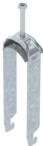
Staffa reggicavo con ancoraggio tipo U, coppa plastica in polipropilene. Per il montaggio verticale e orizzontale di 3 cavi singoli su profilato a C con scanalatura di larghezza 18 mm o 22 mm. Dotata di vite SW10 per il serraggio della coppa tramite testa esagonale o intaglio a croce. Per il montaggio in ambiente interno ed esterno. Separazione tra due cavi garantita dalla coppa doppia. Si raccomanda l'uso della controcoppa, da ordinare separatamente.
