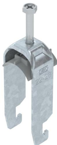
Staffa reggicavo con ancoraggio tipo U, coppa plastica in polipropilene. Per il montaggio verticale e orizzontale di 2 cavi singoli su profilato a C con scanalatura di larghezza 18 - 22 mm. Dotata di vite SW10 per il serraggio della coppa tramite testa esagonale o intaglio a croce. Per il montaggio in ambiente interno ed esterno. Separazione tra due cavi garantita dalla coppa doppia. Si raccomanda l'uso della controcoppa, da ordinare separatamente.
