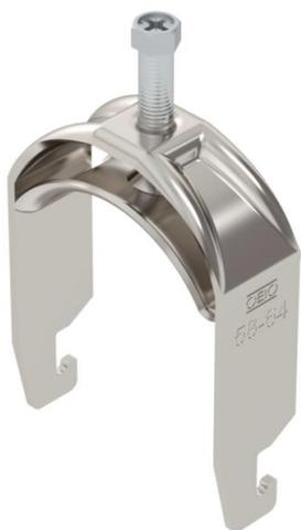
Staffa reggicavo con ancoraggio tipo U, coppa in metallo con bordi arrotondati a protezione del cavo. Per il montaggio verticale e orizzontale di 1 cavo singolo su profilato a C con scanalatura di larghezza 18 - 22 mm. Dotata di vite SW10 per il serraggio della coppa tramite testa esagonale o intaglio a croce. Per il montaggio in ambiente interno ed esterno. Si raccomanda l'uso della controcoppa, da ordinare separatamente.
