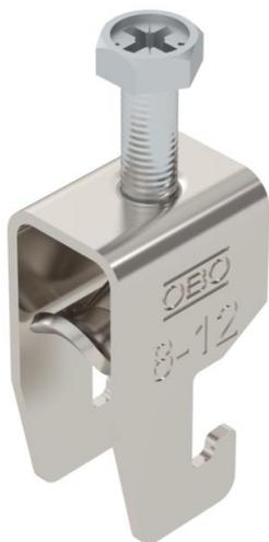
Staffa reggicavo con ancoraggio tipo U, coppa in metallo con bordi arrotondati a protezione del cavo. Per il montaggio verticale e orizzontale di 1 cavo singolo su profilato a C con scanalatura di larghezza 18 - 22 mm. Dotata di vite SW10 per il serraggio della coppa tramite testa esagonale o intaglio a croce. Per il montaggio in ambiente interno ed esterno. Si raccomanda l'uso della controcoppa, da ordinare separatamente.
