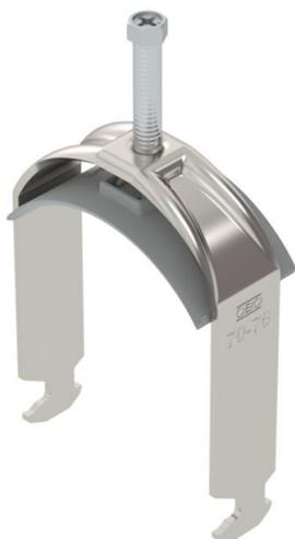
Staffa reggicavo con ancoraggio tipo H, coppa plastica in polipropilene. Per il montaggio verticale e orizzontale di 1 cavo singolo su profilato a C con scanalatura di larghezza 16 - 17 mm. Dotata di vite SW10 per il serraggio della coppa tramite testa esagonale o intaglio a croce. Per il montaggio in ambiente interno ed esterno. Si raccomanda l'uso della controcoppa, da ordinare separatamente.
