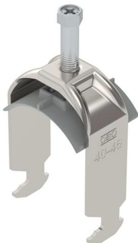
Staffa reggicavo con ancoraggio tipo H, coppa plastica in polipropilene. Per il montaggio verticale e orizzontale di 1 cavo singolo su profilato a C con scanalatura di larghezza 16 - 17 mm. Dotata di vite SW10 per il serraggio della coppa tramite testa esagonale o intaglio a croce. Per il montaggio in ambiente interno ed esterno. Si raccomanda l'uso della controcoppa, da ordinare separatamente.
