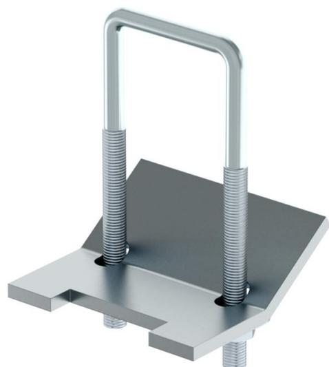
Elemento di collegamento al fissaggio su entrambi i lati di profilati ai supporti in acciaio. Il fissaggio è possibile indipendentemente dall'ordine dell'apertura delle guide. La lunghezza delle guide dovrebbe avere almeno la larghezza del supporto in acciaio + 2 x 50 mm.
