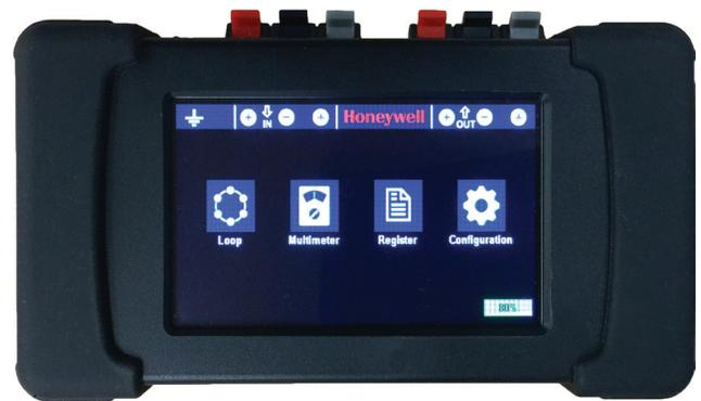
***POL-200-TS** è un dispositivo portatile compatto con interfaccia grafica che aiuta l'installatore a programmare e testare e mantenere gli impianti di rivelazione incendi indirizzati di Notifier Italia.*
