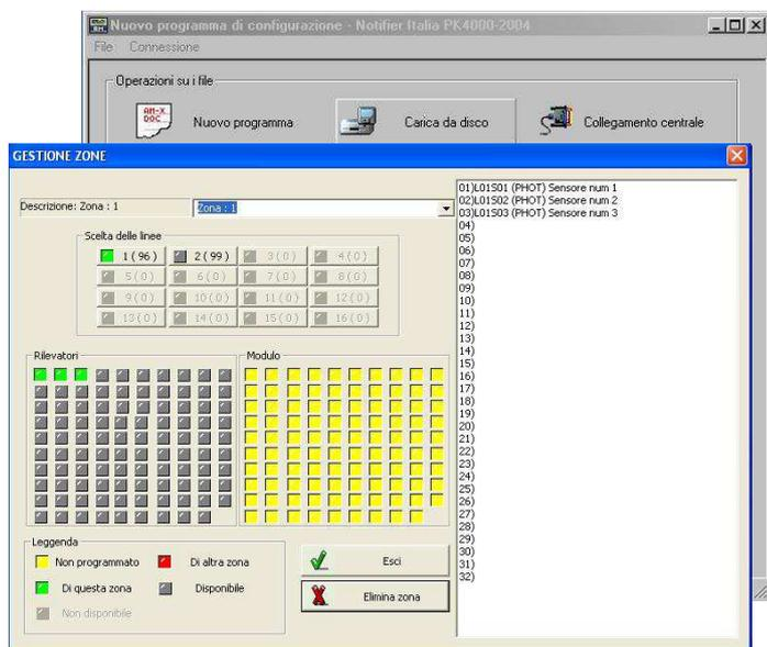
Le programmazioni che possono essere eseguite con questo programma sono le stesse che l'operatore può eseguire lavorando direttamente sulla centrale. Compatibile con tutte le versioni di Windows. Connessione alla centrale con linea seriale RS-232.
