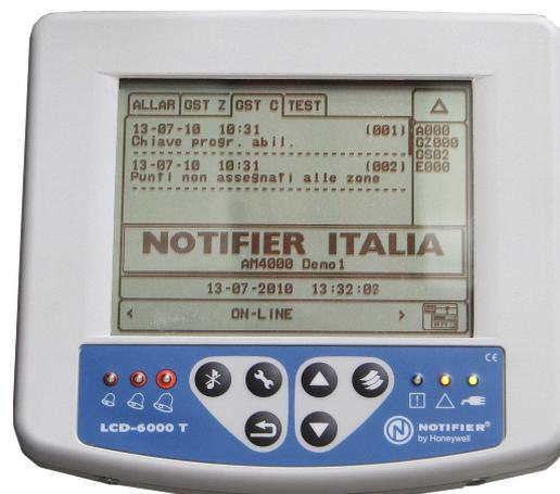
Il pannello remoto è dotato di un Display LCD grafico retro-illuminato 320x240, che consente una visione ottimale in tutte le condizioni di luce grazie ad un'ottima luminosità e un elevato contrasto.
