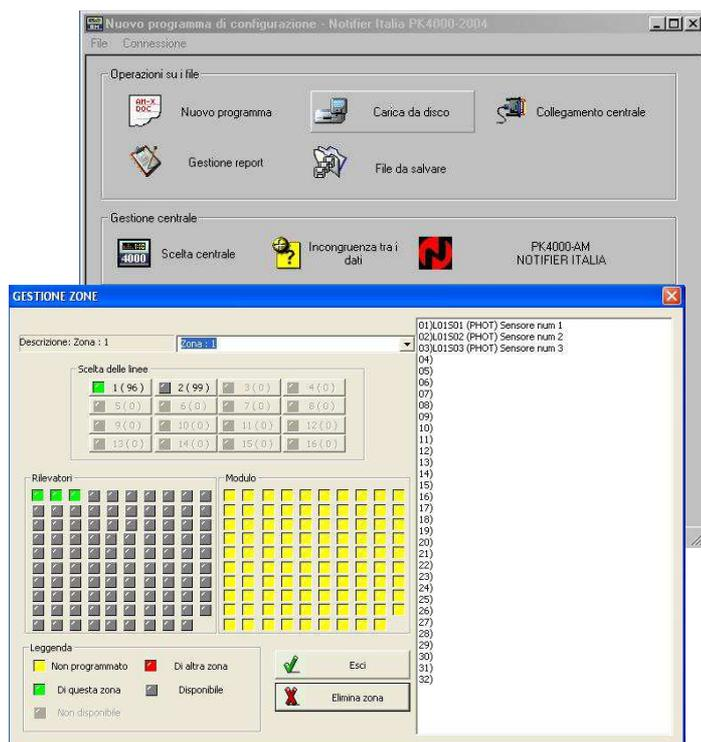
Le programmazioni che possono essere eseguite con questo programma sono le stesse che l'operatore può eseguire lavorando direttamente sulla centrale. Compatibile con tutte le versioni di Windows. Connessione alla centrale con linea seriale RS-232.
