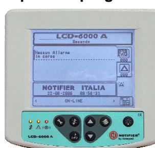
Permette la visualizzazione degli eventi attivi in centrale, relativi ai dispositivi, o alle zone indicate nella configurazione che viene effettuata tramite PC grazie al software PK.
