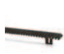
ROA6 CREMAGLIERA M4 25x20x1000 mm ASOLATA IN NYLON CON INSERTO METALLICO. PER CANCELLI DI PESO MAX 500 kg. PZ./CONF. 10
